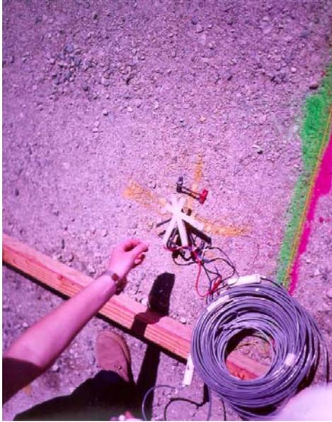
FIGURE 42. STRAIN GAGE INSTALLATION
